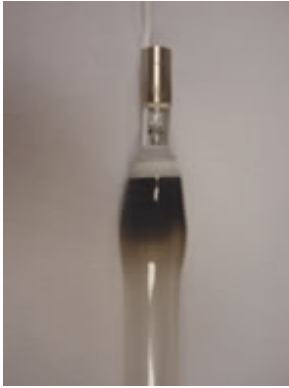
Lámpara mal Ventilada
